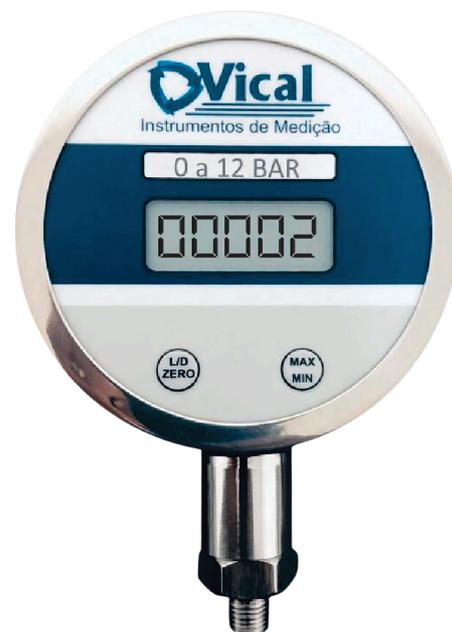
O Manômetro Digital VICPRESS 1001 é um instrumento c/ alta precisão de medição, sendo indicado tanto para uso como padrão em laboratórios como para monitoração em campo. Desenvolvido com a mais moderna técnica de condicionamento de sinais e utilizando sensores piezo-resistivos, o instrumento permite a amostragem de grandezas de pressão com alta resolução em um display de cristal líquido de 4½ dígitos.
